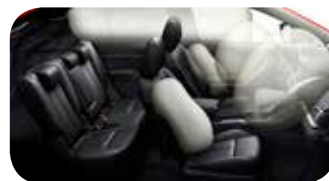
Napełnione poduszki powietrzne
